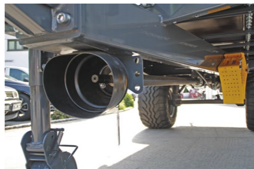
Zapfwellenanschluß für Streuteller
