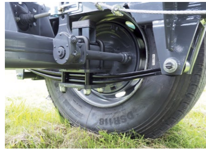
Niederbauweise - Feder unter Achse
