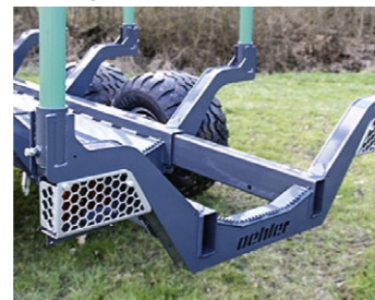
Beleuchtungsanlage mit Schutzgitter
