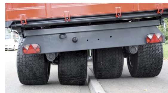
OL EDK 60 SG Höhenausgleich durch Pendelachse
