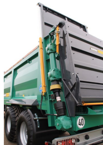
Antrieb über Kardanwelle
