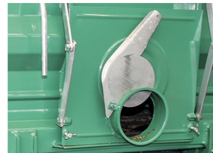
Kornschieber mit Feindosierung
