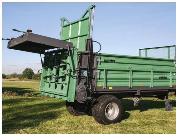
OL STE 80 mit Stauschieber
