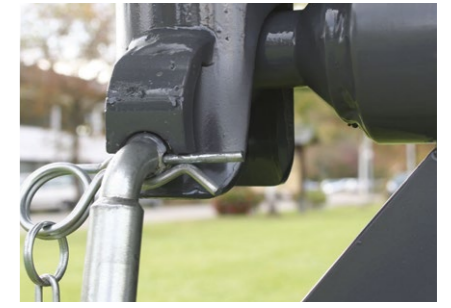
Kipplager mit Überkreuzstecksicherung
