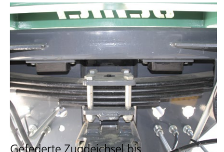
Gefederte Zugdeichsel bis max. 4t Stützlast
