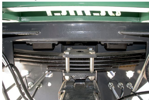
Gefederte Zugdeichsel bis max. 4 t Stützlast
