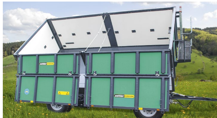
Seitenbordwände horizontal geteilt
