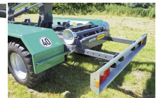
OL THKL 130 ausziehbarer Unterfahrtschutz
