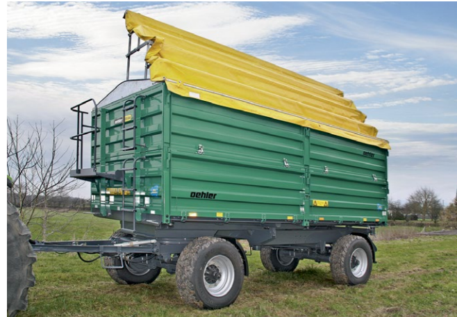
OL ZDK 180 mit hydraulischem Cabrioverdeck
