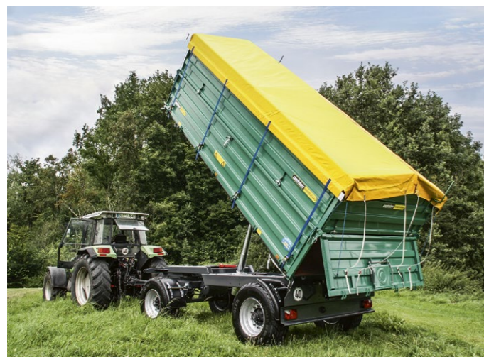
OL ZDK 180 U mit Aufsatz und Rollplane
